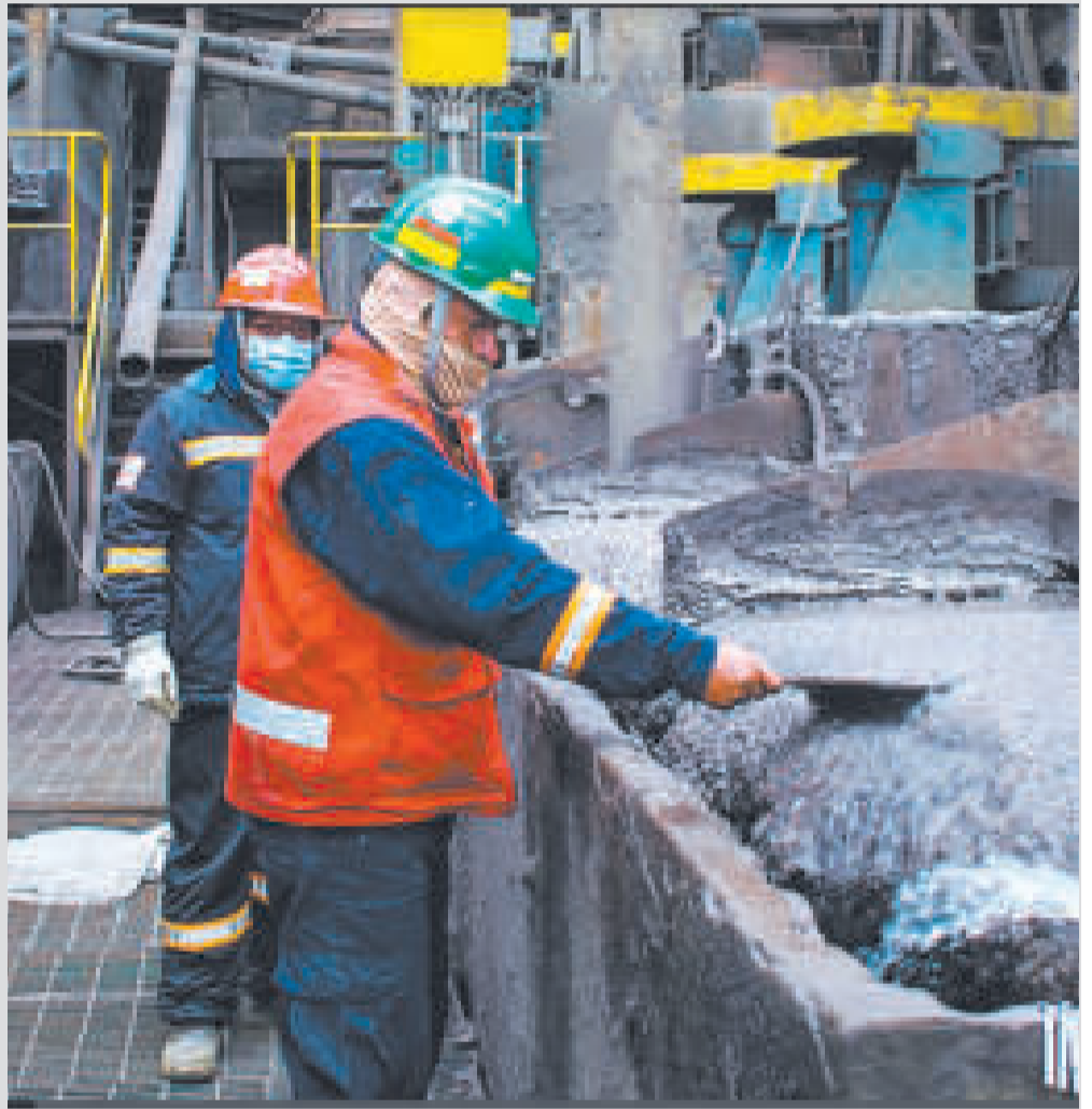
Tratamiento del concentrado de zinc en la minera Colquiri.
