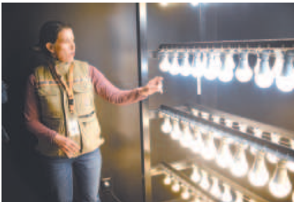
El Laboratorio de Fotometría, que mide la calidad de los focos LED.
