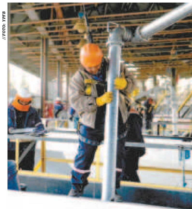
La prueba de “varilla” luego de la carga al camión cisterna.
